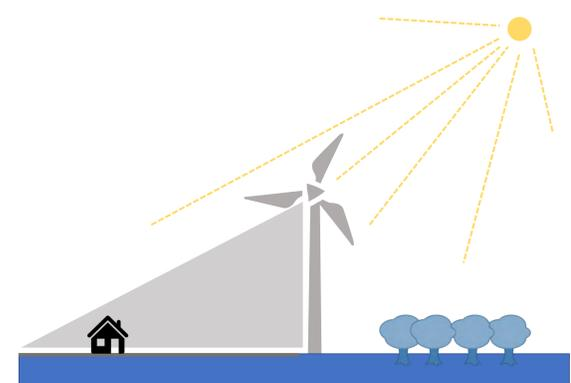
(Möglicher) Schattenwurf an den Immissionsorten: Die Anlage wird vom Schattenmodul abgeschaltet
